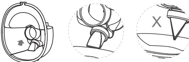
2. Coloque el diafragma de silicona (c) en la copa colectora (f) de acuerdo con la imagen y presione firmemente.
