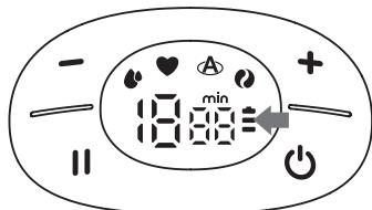
Zodra tijdens het opladen drie permanent brandende streepjes worden weergegeven, is de accu volledig opgeladen. Nu kan er gedurende minimaal 100 min. worden gekolfd. Afhankelijk van de gekozen modus en het ingestelde vacuüm kan deze tijdsduur variëren.
