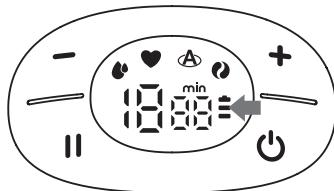
La batteria ricaricabile è completamente carica quando, durante la ricarica, compaiono tre barre accese a luce fissa. A questo punto è possibile utilizzare il tiralatte per almeno 100 minuti. Tale durata può variare a seconda della modalità selezionata e della potenza del vuoto impostata.
