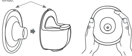
4. Montare il motore del tiralatte (b) come illustrato in figura. Premere a fondo.
