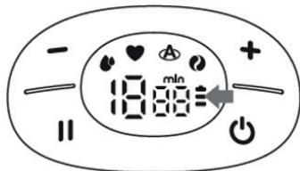
Het duurt ca. twee uur voor de Ardo Melia volledig is opgeladen. Zodra tijdens het opladen drie permanent brandende streepjes worden weergegeven, is de accu volledig opgeladen. Nu kan er gedurende minimaal 100 min. worden gekolfd. Afhankelijk van de gekozen modus en het ingestelde vacuüm kan deze tijdsduur variëren.
