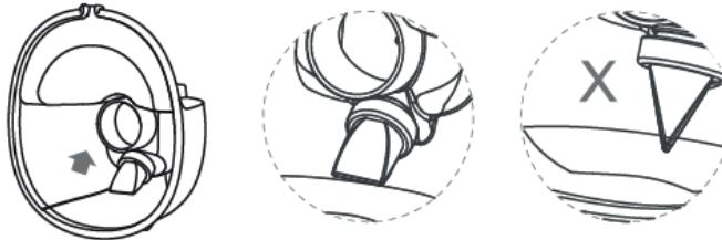
2. Das Silikon-Diaphragma (c) gemäss Abbildung in die Auffangschale (f) einsetzen und gut festdrücken.
