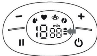
Es dauert ca. zwei Stunden, bis die Ardo Melia vollständig aufgeladen ist. Sobald während des Aufladens drei durchgängig leuchtende Balken angezeigt werden, ist der Akku vollständig geladen. Nun kann während mindestens 100 min gepumpt werden. Abhängig vom gewählten Modus und der eingestellten Vakuumstärke kann diese Dauer variieren.
