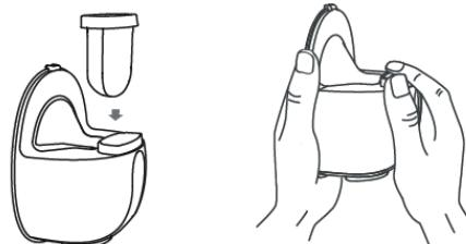
3. Inserire la coppa (a) nella calotta di raccolta (f). Le scanalature (contrassegnate dalle frecce in basso) devono sovrapporsi. Usando entrambe le mani, posizionare il bordo della coppa (a) intorno al bordo della calotta di raccolta (f) e premere a fondo.
