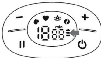
Per caricare completamente Ardo Melia sono necessarie circa due ore. La batteria ricaricabile è completamente carica quando, durante la ricarica, compaiono tre barre accese a luce fissa. A questo punto è possibile utilizzare il tiralatte per almeno 100 minuti. Tale durata può variare a seconda della modalità selezionata e della potenza del vuoto impostata.
