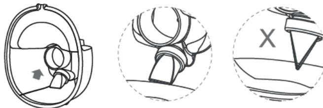
2. Inserire il diaframma in silicone (c) nella calotta di raccolta (f) come illustrato in figura e premere a fondo.
