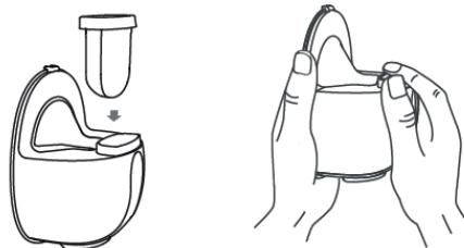
3. Brustglocke (a) in die Auffangschale (f) einsetzen. Die Aussparungen (unten mit Pfeilen markiert) müssen aufeinanderliegen. Den Rand der Brustglocke (a) rundherum mit beiden Händen über die Kante der Auffangschale (f) stülpen und gut festdrücken.
