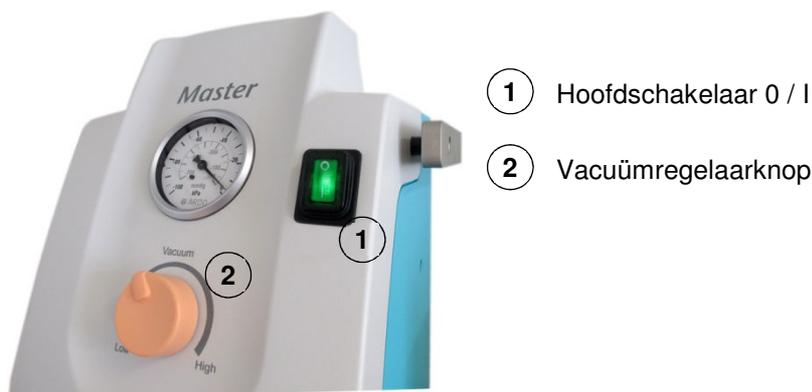
Apparaat is aangesloten op de stroomvoorziening.
