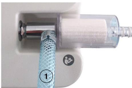
Le raccord du vide du régulateur de vide à pied doit être inséré entre la pompe et le filtre antibactérien hydrophobe.
