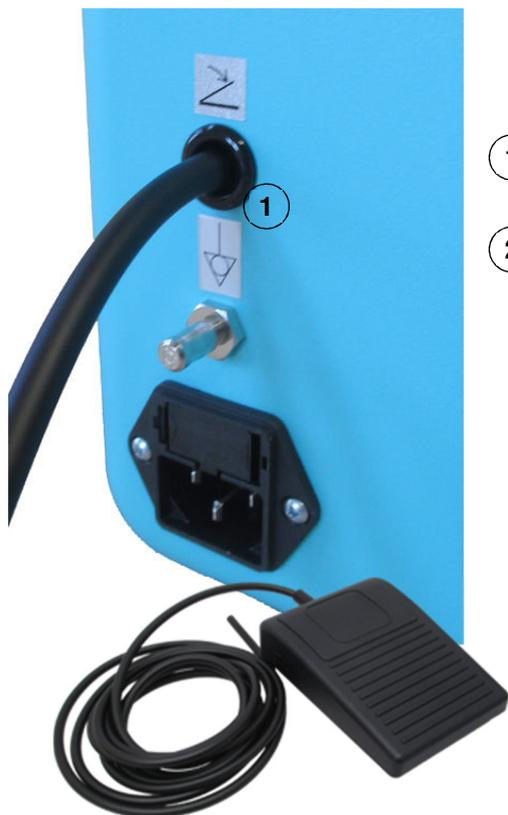
① Emmancher le tuyau d'air de la commande à pied sur le raccord de la commande à pied jusqu'à la butée.
