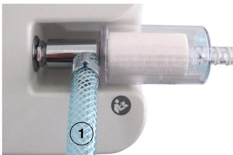
① L'attacco per il vuoto del regolatore del vuoto a pedale deve essere inserito tra la pompa e il filtro antibatterico idrofobo. (Ciò evita la possibile contaminazione del regolatore del vuoto a pedale).
